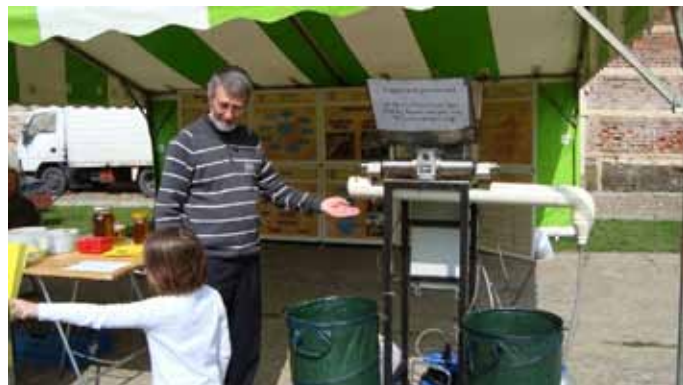
6. Demonstratie van de ENERKO pers die tot 6 kg koolzaad per uur kan persen
